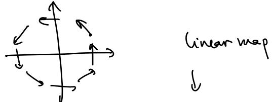
$$\Rightarrow \varphi_x^t(x, y) = \begin{pmatrix} \cos t & -\sin t \\ \sin t & \cos t \end{pmatrix} \begin{pmatrix} x \\ y \end{pmatrix}$$
